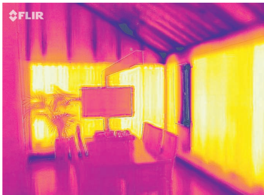
Een warmtescan laat de wandverwarming goed zien.
